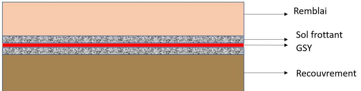
Figure 33 : Ajout d'un sol frottant pour augmenter la résistance des interfaces GSY-remblai et GSY – recouvrement
