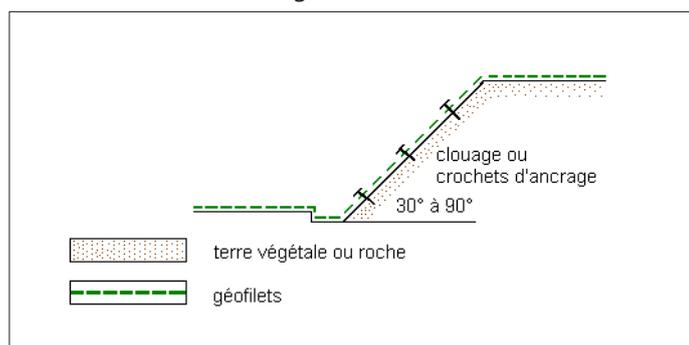
» Avec tranchée d'ancrage en tête de remblai
